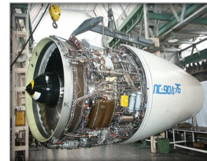
Двигатель ПС-90А-76 - турбовентиляторный, двухконтурный, со смешением потоков наружного и внутреннего контуров.
