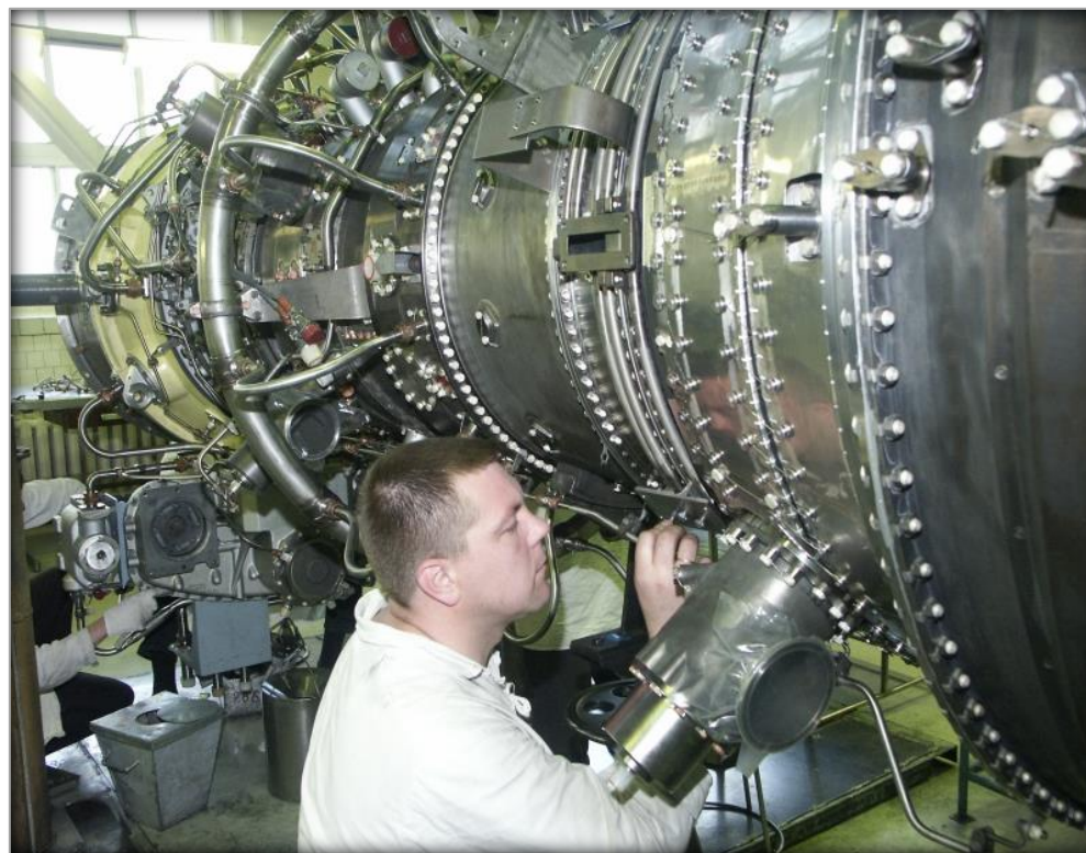
Двигатель ПС-90А-76 - турбовентиляторный, двухконтурный, со смешением потоков наружного и внутреннего контуров.
